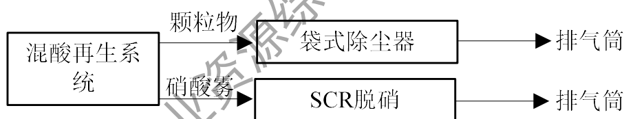
图 7.2-3 混酸系统废气处理工艺
